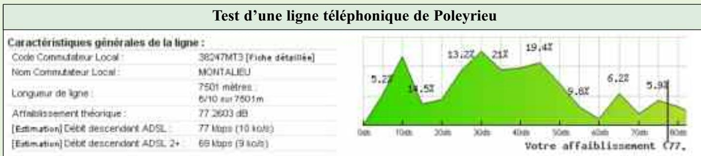
*On peut apercevoir une atténuation du signal de 77 dB n'autorisant aucune connexion haut débit ! Même le RE-ADSL ne parvient pas à fournir un signal suffisant au delà de 7 km*
