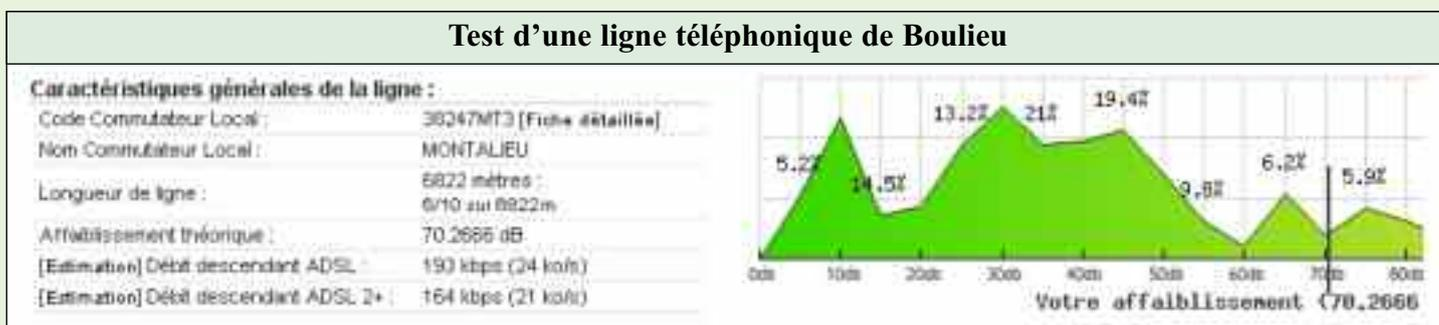
*70 dB semble une limite. Néanmoins une connexion de 512 Ko devient possible dans le hameau du fait de l'installation par Fance Télécom du RE-ADSL permettant de "pousser" le signal au delà de 6 km*
